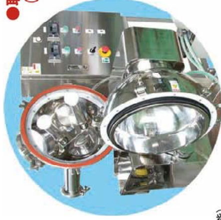
加熱ユニット (冷却仕様に變更可能)
